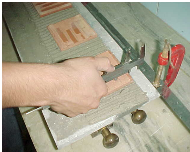
Fotografia 47 – Determinação do deslizamento
