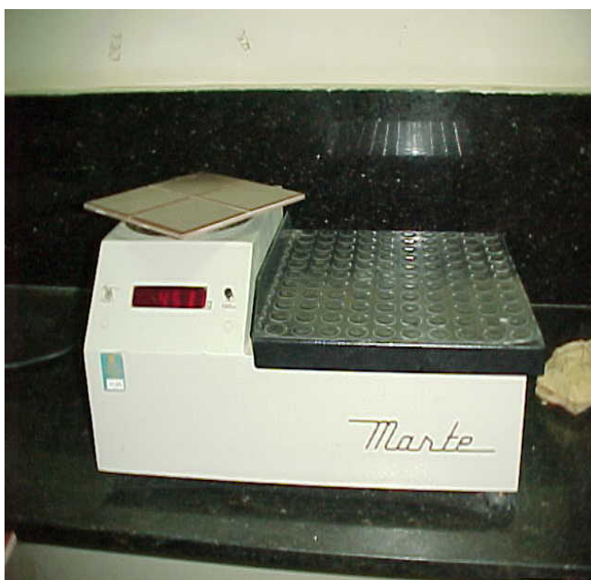
Fotografia 60 – Balança utilizada para o ensaio de absorção de água
