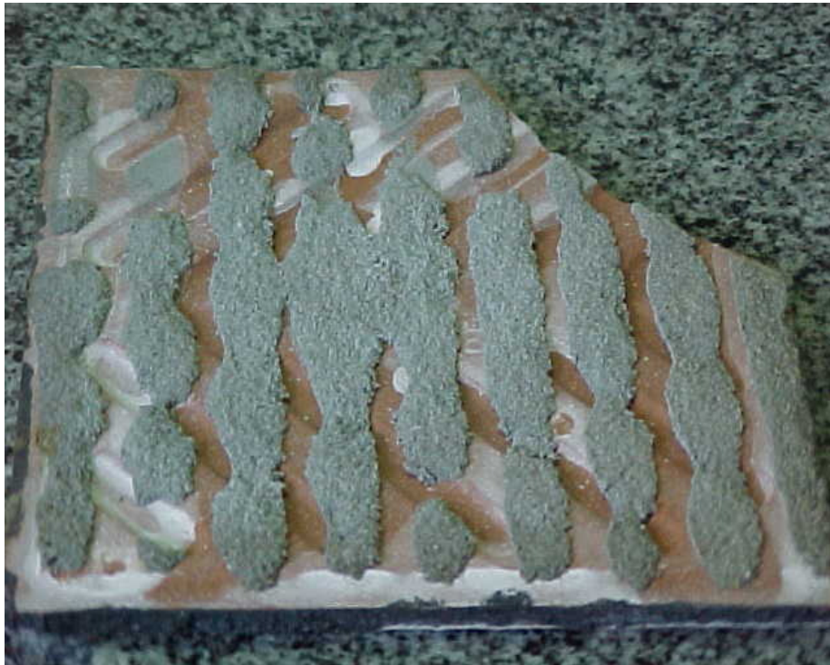
Fotografia 20 - Ausência de esmagamento completo dos cordões da argamassa colante
