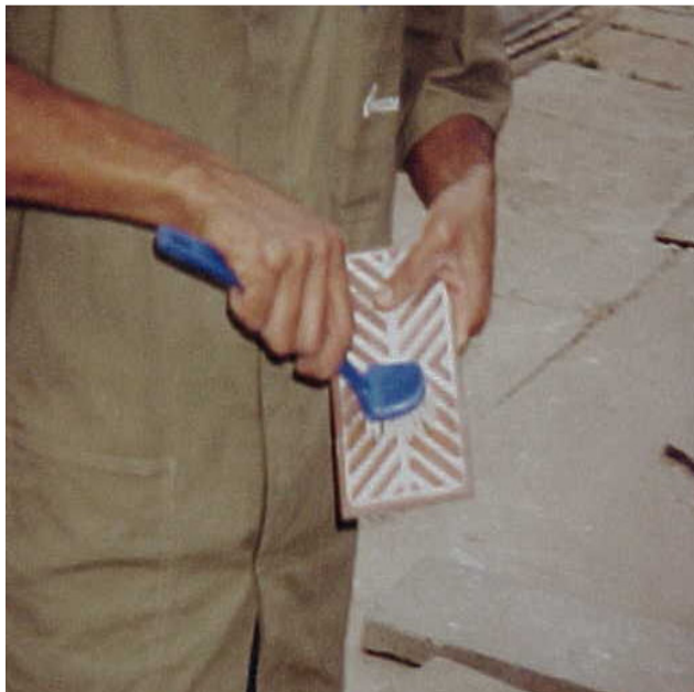
Fotografia 12 - Limpeza do engobe
