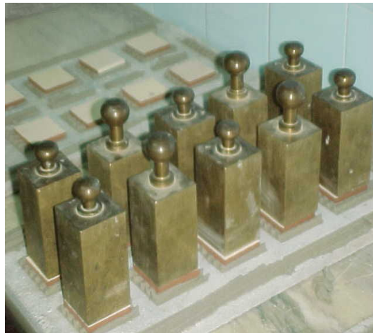
Fotografia 42 – Determinação de tempo em aberto da argamassa colante
