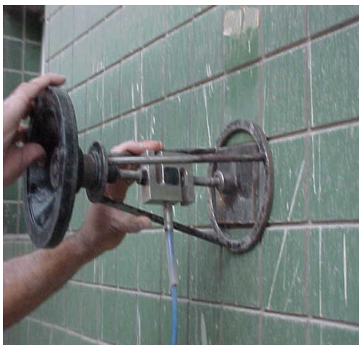
Fotografia 56 - Resistência a tração do revestimento
