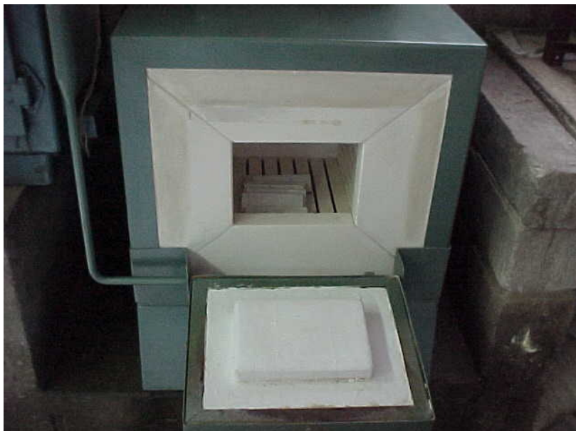
Fotografia 63 – Mufla utilizada para o ensaio de expansão por umidade
