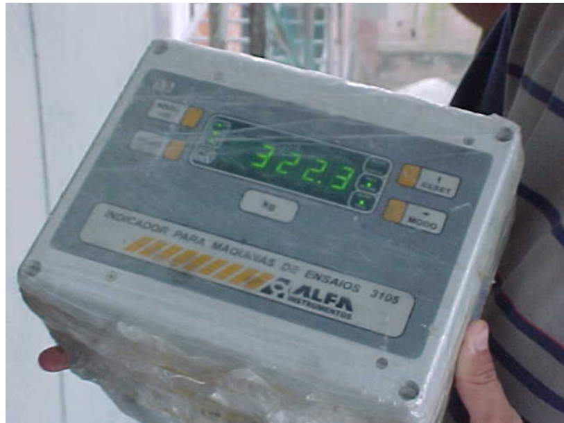
Fotografia 53 - Resistência a tração do emboço
