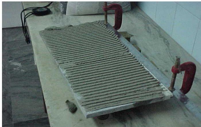
Fotografias 43 e 44 – Determinação do deslizamento
