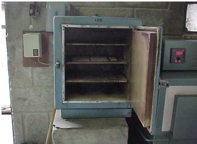
Fotografia 59 – Estufa utilizada para ensaio de absorção de água
