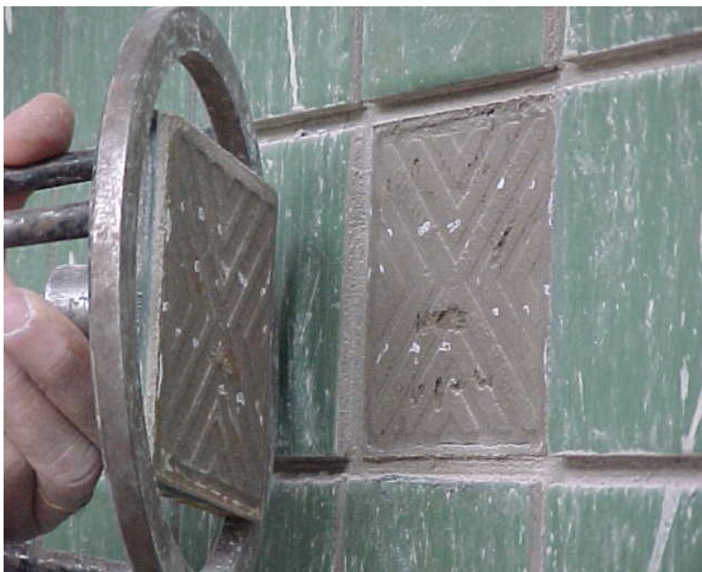
Fotografia 57 - Resistência à tração do revestimento
